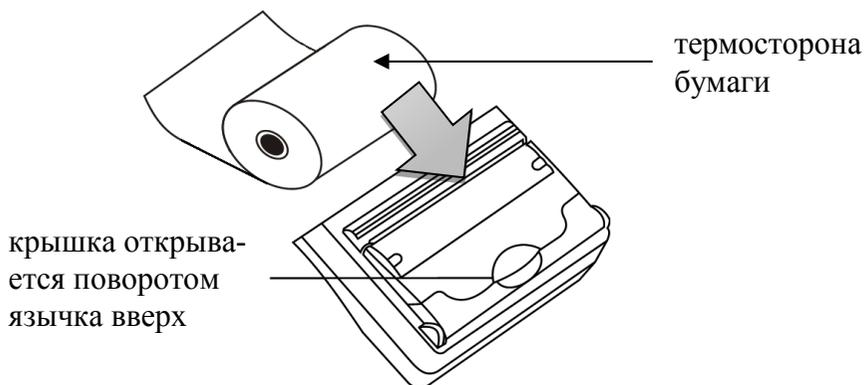
Рисунок 27 – Внешний вид крышки отсека для бумаги принтера
