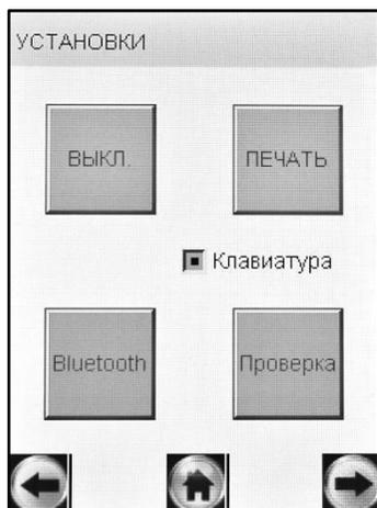
**ВЫКЛ.** – Установка времени автоматического отключения
