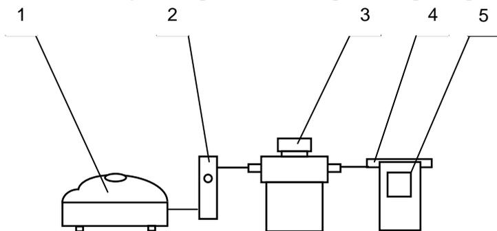
1 – компрессор; 2 – ротаметр; 3 – генератор ГС;
