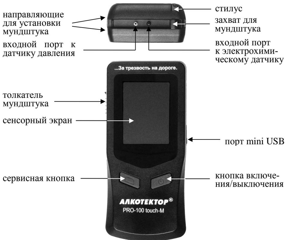
Рисунок 2 – Общий вид анализатора
