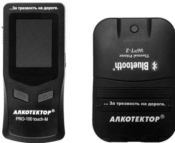
Рисунок 1 – Внешний вид анализатора с принтером
